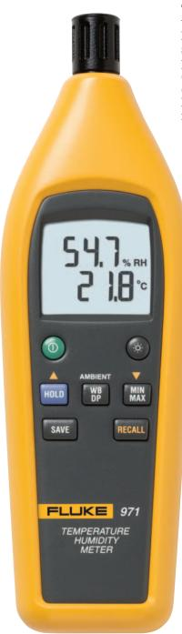
Tome lecturas de humedad y temperatura exactas en el aire. La temperatura y la humedad son dos factores importantes para mantener niveles de confort óptimos y una buena calidad del aire de interiores. La herramienta Fluke 971 es invalorable para los técnicos de
